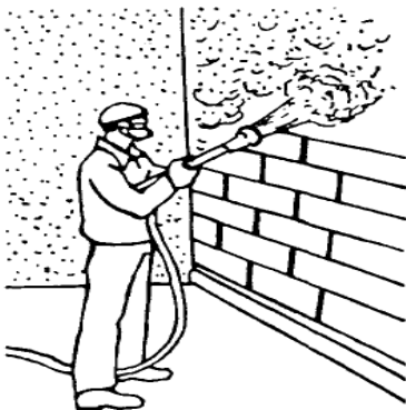
Рисунок 2.23 – Последовательное нанесение слоев обрызга, грунта
