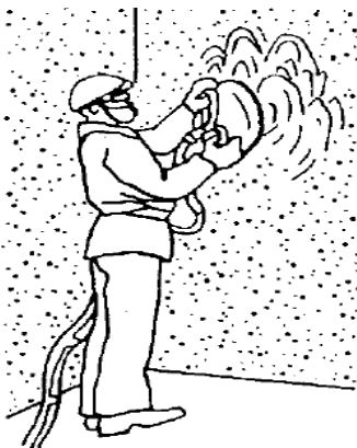
Рисунок 2.25 – Механизированная затирка поверхности
